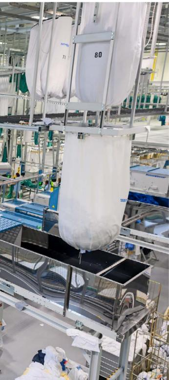
(oben) Blick in die Halle auf Faltmaschinen, Fördertechnik und Abwurfstationen.
